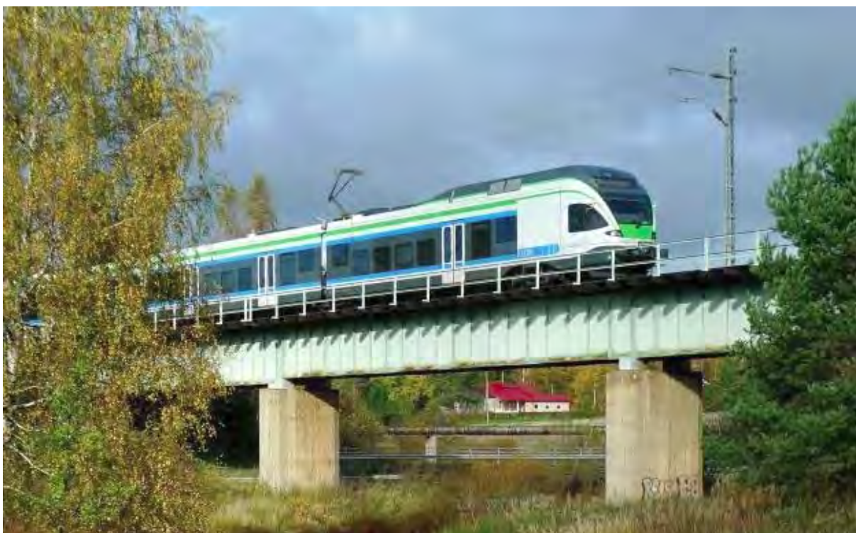
Potentiaalisin uuden kaluston tyyppi on Flirt-juna (Sm5) erilaisissa muodoissaan diesel-, sähkö- tai duoversiona.
